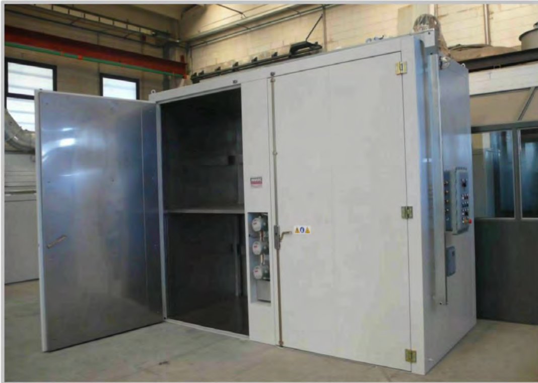
Komora grzewcza do 16 beczek, temperatura maks. 150°C, ogrzewanie elektryczne, certyfikat ATEX.
