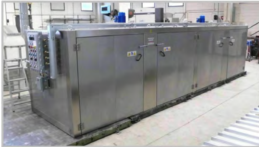
(1/2) PRZÓD: Komora grzewcza do 16 beczek, układ poziomy, podzielony na 2 niezależnie przedziały po 8 beczek, temperatura maks. 150°C, ogrzewanie parowe, certyfikat ATEX, konstrukcja wykonana ze stali nierdzewnej AISI304.
