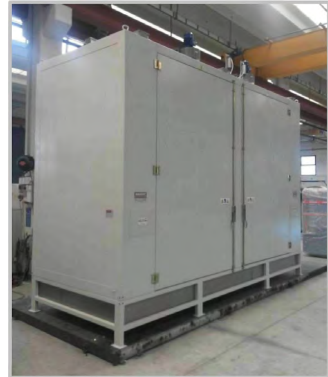
Komora grzewcza do 16 beczek, podzielony na 2 przedziały po 8 beczek, temperatura maks. 150°C, ogrzewanie elektryczne, wyposażony w podstawę ramową z nóżkami i wannę wychwytową, płyty wykończenia wewnętrznego wykonane ze stali nierdzewnej AISI304, system wentylacji wyciągowej i system blokady drzwi.
