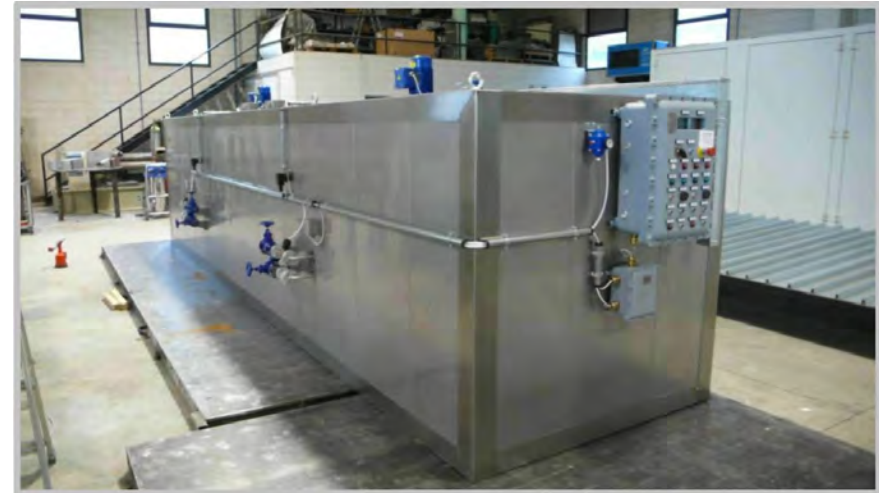
(2/2) TYŁ: Komora grzewcza do 16 beczek, układ poziomy, podzielony na 2 niezależnie przedziały po 8 beczek, temperatura maks. 150°C, ogrzewanie parowe, certyfikat ATEX, konstrukcja wykonana ze stali nierdzewnej AISI304.
