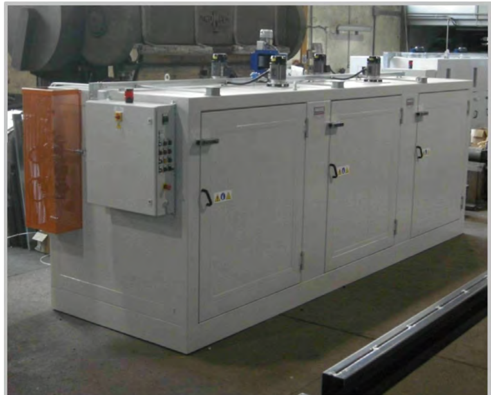
Komora grzewcza do 12 beczek, układ poziomy, temperatura maks. 100°C, ogrzewanie parowe, wyposażony w wannę wychwytową i system wentylacji wyciągowej.
